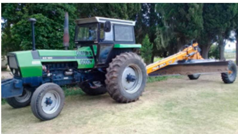
176. Muchas Comunas han incorporado niveladoras de arrastre a su equipamiento, con menores costos de adquisición, operación y mantenimiento que una motoniveladora.
