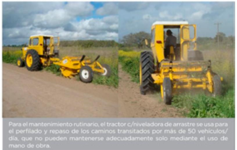
Para el mantenimiento rutinario, el tractor c/niveladora de arrastre se usa para el perfilado y repaso de los caminos transitados por más de 50 vehículos/día, que no pueden mantenerse adecuadamente solo mediante el uso de mano de obra.
