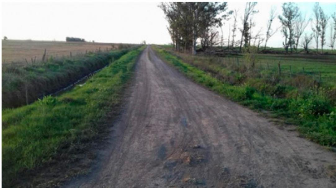
77. "Ambiente vial" con suelo salitroso y presencia de sodio, susceptible a las voladuras.
